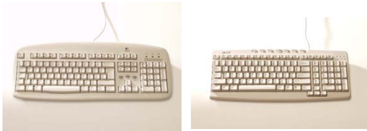
Figuur 7: Een voorbeeld van een traditioneel alfanumeriek toetsenbord en een kleinere variant. Beide hebben een apart numeriek deel, maar bij het rechter voorbeeld zijn de navigatietoetsen efficiënter ingedeeld en is het toetsenbord in totaal 7 cm smaller terwijl de grootte van de toetsen gelijk is.
